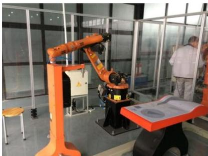
✓ **KUKA KR5 ARC (TIG、MIG) 工业机器人**
