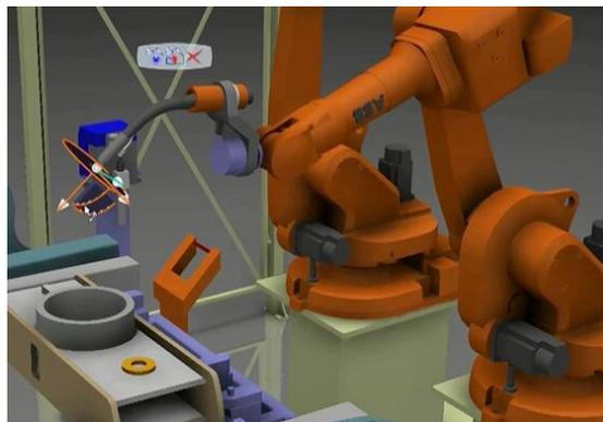
图：弧焊焊枪
