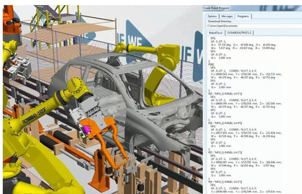
图：工业机器人离线编程
