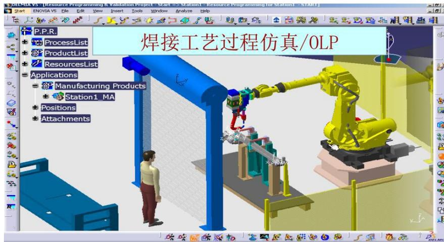
图：机器人点焊
