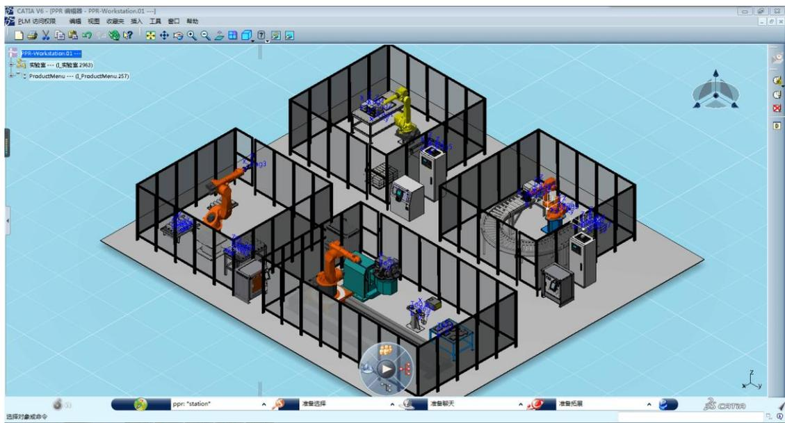
图七 工业机器人智能制造生产线建模示意图
